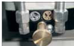
Regulacja siły za pomocą zaworów by-pass
