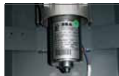
Silnik elektryczny o niskim zużyciu i enkoder
