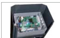
Centrala sterująca umieszczona na górze szlabanu
