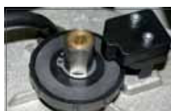
Mechaniczne sprzęgło dwutarczowe oraz enkoder w standardzie
