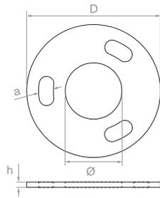
Podstawa słupa – mocowanie do podłoża
