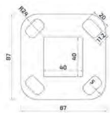
Podstawa słupa – mocowanie do podłoża
