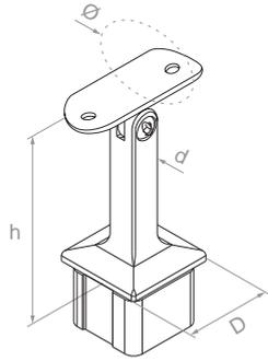
**Łącznik słupka przegubowy**
