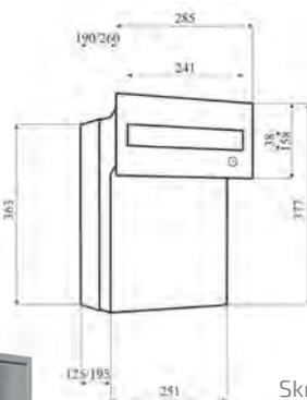
Skrzynka przelotowa z szufladą i przyciskiem dzwinkowym PM 6PN G (260-410), elementy ze stali nierdzewnej
