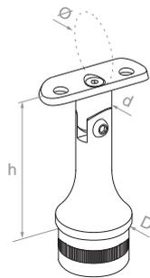
Łącznik słupka przegubowy
