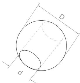
**Kula do wklejenia z otworem przelotowym**
