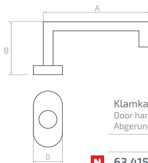
Klamka RAVENNA zaokrąglona z szyldem owalnym, nierdzewna
