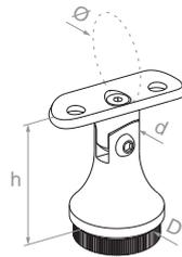
Łącznik słupka przegubowy
