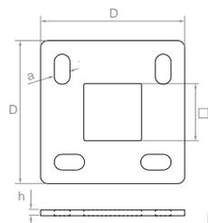
Podstawa słupa – mocowanie do podłoża
