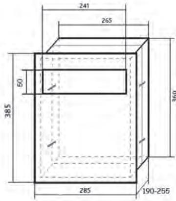
Skrzynka przelotowa z szufladą i przyciskiem dzwinkowym, do ogrodzeń modułowych PM WPN 20G (190-255), elementy ze stali nierdzewnej
