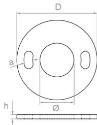
Podstawa słupa – mocowanie do podłoża
