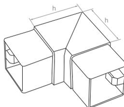
Łącznik pionowy do profilu – kolano 90°C
