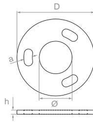
Podstawa słupa – mocowanie do podłoża
