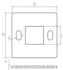
Podstawa słupa – mocowanie do podłoża
