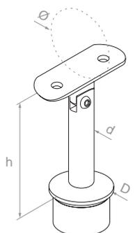
Łącznik słupka przegubowy
