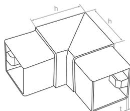
**Łącznik pionowy do profilu – kolano 90°C**
