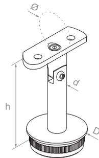
Łącznik słupka przegubowy
