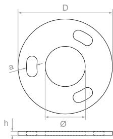
Podstawa słupa – mocowanie do podłoża
