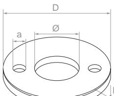
Podstawa słupa – mocowanie do podłoża
