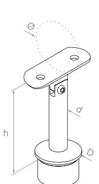
**Łącznik słupka przegubowy**
