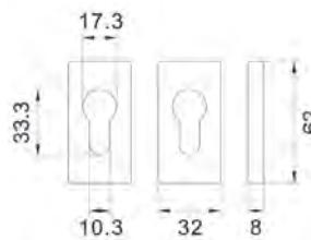
Szyld prostokątny - stal nierdzewna
