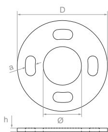
Podstawa słupa – mocowanie do podłoża
