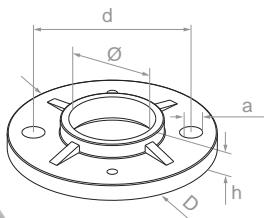
Podstawa słupa – mocowanie do podłoża
