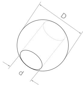
**Kula do wklejenia z otworem przelotowym**
