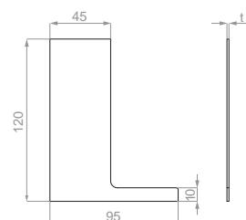
Zaślepka boczna lewa, do balustrad, profil L
