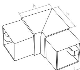
Łącznik pionowy do profilu – kolano 90°C
