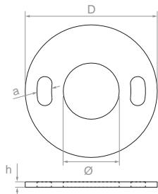
Podstawa słupa – mocowanie do podłoża
