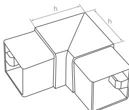
Łącznik pionowy do profilu - kolano 90°C
