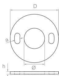
Podstawa słupa – mocowanie do podłoża
