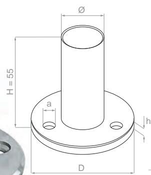
Podstawa słupa – mocowanie do podłoża
