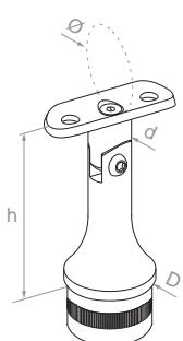
**Łącznik słupka przegubowy**
