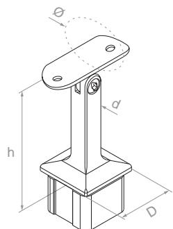
**Łącznik słupka przegubowy**
