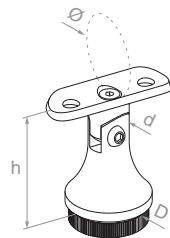
**Łącznik słupka przegubowy**
