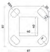
Podstawa słupa – mocowanie do podłoża
